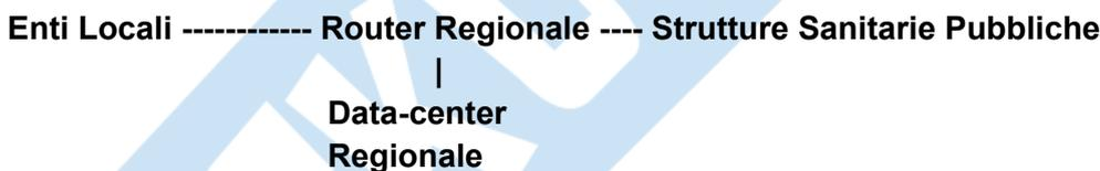
Con l'introduzione del servizio anche per le strutture sanitarie private convenzionate, che verranno identificate nella sottorete 10.100.0.0/16, l'evoluzione della rete prevede l'ampliamento dell'infrastruttura esistente. Il nuovo segmento sarà dedicato esclusivamente alla connettività delle strutture sanitarie private convenzionate con il data-center regionale, senza fornire loro accesso diretto a Internet per preservare la sicurezza e il controllo dell'accesso ai dati sensibili.
